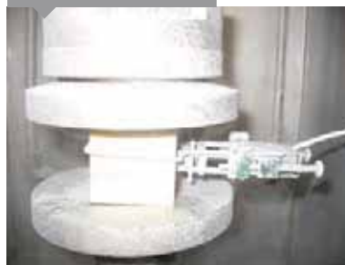
Essais en compression à -170^{\circ}\text{C} sur la mousse polyuréthanne.
